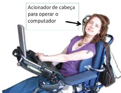
Figura 37 - Mulher em cadeira de rodas utilizando acionador de cabeça para operar computador
